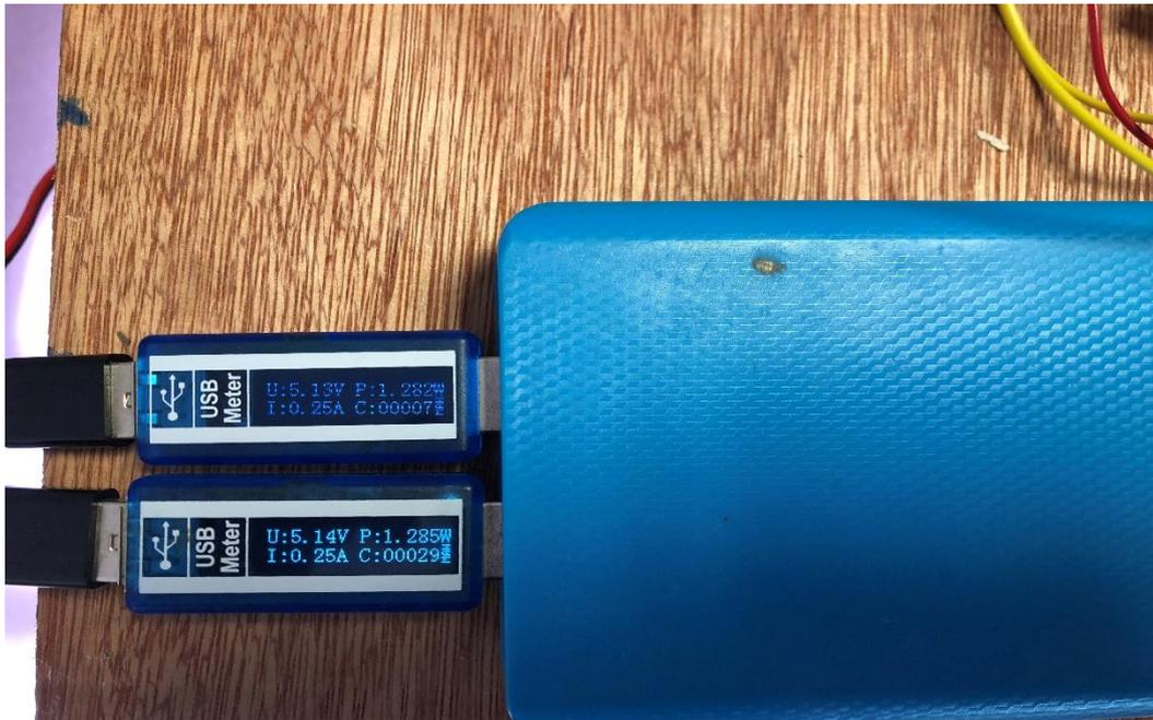
La fontaine d'eau électrique est alimentée par une batterie, nous utilisons deux multimètres USB qui permettent de renseigner en temps réel la consommation d'énergie du système. Notre système consomme moins de 3w lorsque la distribution de l'eau est effectif.
