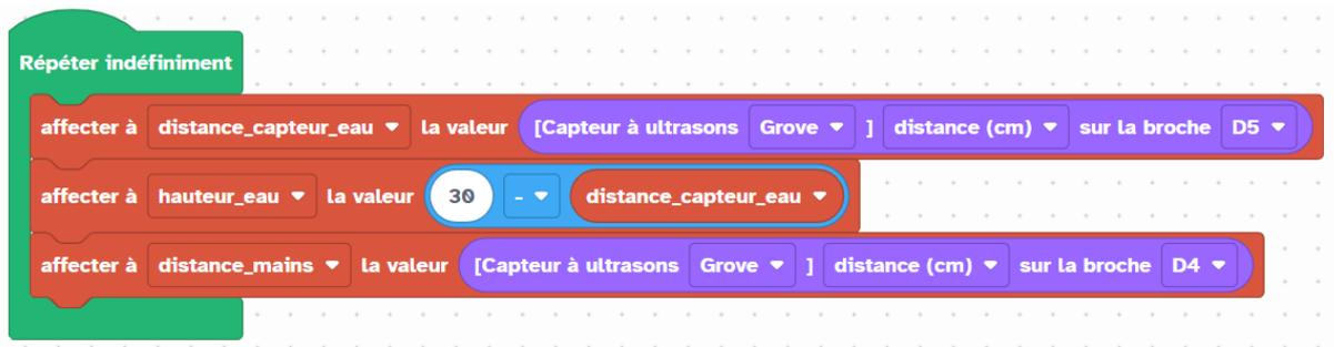
Avant de pouvoir calculer le volume d'eau du réservoir, il nous a fallu déterminer la hauteur de l'eau et pour se faire nous avons conçu l'assemblage ci-dessus.
